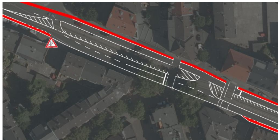
Abbildung 64: Abbau von Führungswechseln auf der Dorstener Straße
